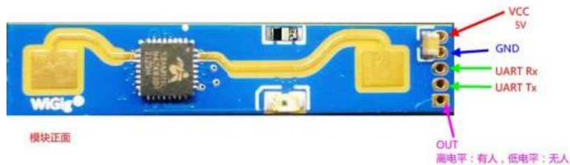
图 6 模块引脚定义图
